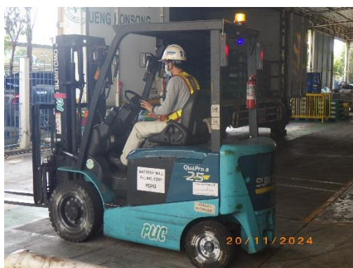
รูปที่ 2-34 รถ Forklift แบบใช้แบตเตอรี่ไฟฟ้า
