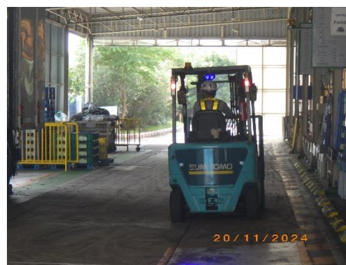
รูปที่ 2-34 รถ Forklift แบบใช้แบตเตอรี่ไฟฟ้า
