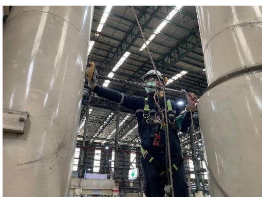
ปล่องที่ 9 การขัดผิวชิ้นงาน Line B2 No.1
